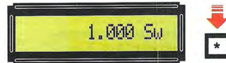
Fig.44 Premendo il tasto * potrete scegliere la "velocità di scansione", che in questo secondo esempio può essere di 1.000 Sw.
