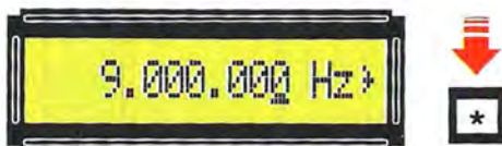
Fig.24 Se sul display appare 9.000.000 Hz > e desiderate modificare tale frequenza di pochi Hertz, premete il tasto * in modo da sottolineare l'ultimo 0 a destra.
