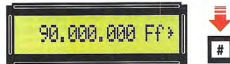
Fig.42 Ripremete il tasto # e quando apparirà "0 Ff" (vedi fig.36) digitate il numero 90.000.000 e poi il tasto di conferma #.
