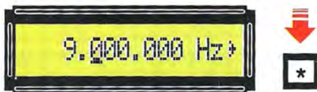
Fig.30 Per variare la frequenza di 100.000 Hz, dovrete premere il tasto * in modo da sottolineare il sesto 0 a partire da destra e poi procedere premendo il tasto +.
