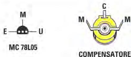
Fig.7 Connessioni dell'integrato stabilizzatore 78L05 viste da sotto, come anche quelle del compensatore di taratura. I due terminali M, che sono in corto, vanno collegati a Massa, mentre il terminale C sulle piste delle bobine (vedi fig.4).
