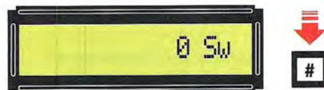
Fig.38 Per far avviare lo Sweep dovrete ripremere il tasto # e in questo modo vedrete apparire sul display la scritta "0 Sw".
