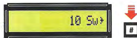
Fig.40 Scelto ad esempio "10 Sw", per avviare questa velocità premete il tasto di conferma # in modo che appaia il segno >.
