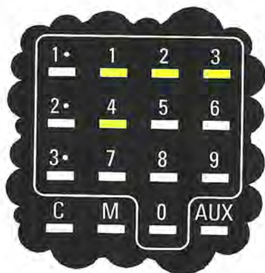
Fig.6 Per eccitare e diseccitare i Relè1 e Relè 2 dovreste premere i tasti 1-2-3-4 che nel disegno appaiono di colore Giallo. Premendo il tasto 1, ecciterete il Relè 1, premendo il tasto 2 lo disecciterete. Premendo il tasto 3 ecciterete il Relè 2, premendo il tasto 4 lo disecciterete. A relè eccitato si accenderà il Diode Led posto in parallelo alla bobina (vedi fig.4).
