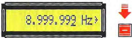
Fig.26 Premendo il tasto - la frequenza scenderà di 1 Hz per volta. Tenendo premuto il tasto + o - il valore della frequenza varierà progressivamente in automatico.
