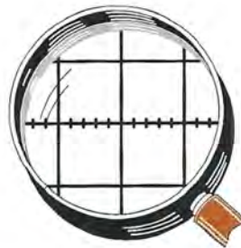
Fig.14 Ogni quadretto è suddiviso in orizzontale in "5 tacche" che vi serviranno per calcolare con maggiore precisione il valore di una frequenza, perchè come spiegato nel testo e indicato nella Tabella N.3, per ogni "tacca" va sommato un preciso valore.
