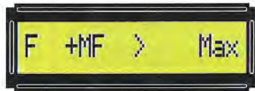
Fig.52 Se vi appare questa scritta significa che avete superato il valore di 120 MHz.
