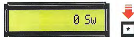
Fig.43 Per far avviare lo Sweep ripremete il tasto * e in questo modo vedrete apparire sul display la scritta "0 Sw".
