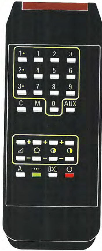
Fig.2 Prospetto del telecomando a raggi infrarossi utilizzato per il Light Controller. Poichè il telecomando è sprovvisto di pila da 9 Volt, dovreste provvedere voi ad inserirla nell'apposito vano aprendo lo sportellino posto sul retro.
