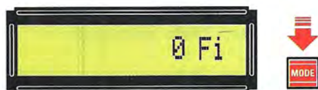
Fig.34 Dopo che sul display sarà apparso 0 Hz premete per "2 volte" il tasto Mode e vedrete apparire "Fi", cioè Frequenza Iniziale.
