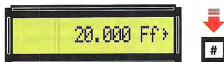
Fig.37 Digitate il numero 20.000, poi premete il tasto di conferma # e sul display vedrete apparire 20.000 Ff >.
