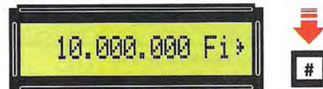
Fig.41 Per cambiare frequenza premete "3 volte" il tasto Mode in modo che appaia "0 Fi" (vedi fig.34) poi scrivete 10.000.000.
