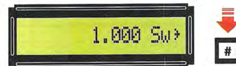
Fig.45 Scelto "1.000 Sw", per avviare la funzione di Sweep premete il tasto di conferma # affinché appaia il segno >.
