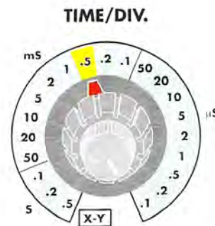
Fig.15 Se misurando un'onda notiamo che questa copre 4 quadretti più "3 tacche", che valgono 0,6 (vedi fig.14), con la manopola del Time/div. posizionata sugli 0,5 millisec., il valore di questa frequenza risulterà esattamente pari a: 1.000 : (0,5 \times 4,6) = 434,78 Hertz.
