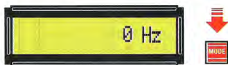
Fig.49 Premete per "2 volte" il tasto Mode in modo che sul display appaia 0 Hz.
