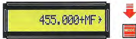
Fig.51 Se non vi ricordate il valore della MF memorizzato premete il tasto Mode.
