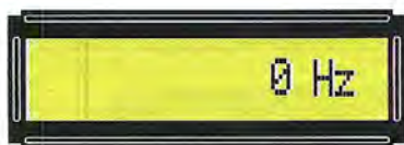
Fig.46 Per sommare un valore di MF accendete il circuito affinché appaia 0 Hz.
