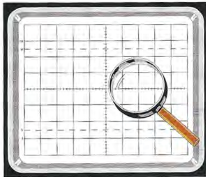
Fig.14 Ogni quadretto è suddiviso in orizzontale in "5 tacche" che vi serviranno per calcolare con maggiore precisione il valore di una frequenza, perchè come spiegato nel testo e indicato nella Tabella N.3, per ogni "tacca" va sommato un preciso valore.
