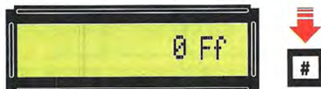
Fig.36 Ripremete il tasto # e sul display apparirà "0 Ff" che indicherà il valore della Frequenza Finale del vostro Sweep.
