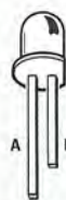
Fig.2 Ricordatevi che nei diodi led il terminale più lungo è l'Anodo e quello più corto il Katodo.
